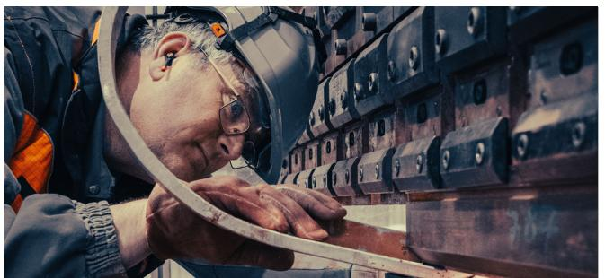
autres qui doivent être formées selon des gabarits pour constituer une entrée d'eau. Chaque tôle doit ensuite être positionnée sur la table de montage en respectant un espacement de 4 millimètres entre elles pour pouvoir être soudées. Enfin, le respect des plans et des tolérances de construction du fournisseur garantira l'atteinte des performances du navire (30 nœuds).
