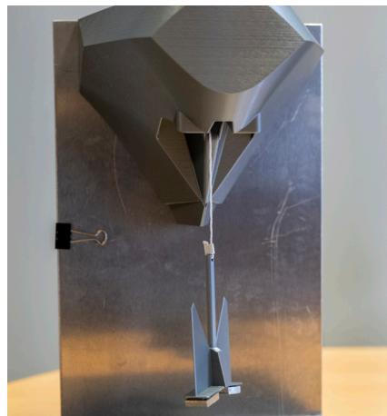
Après 24h d'impression, le BE a pu tester plusieurs scénarios en simulant les opérations de descente et remontée de la ligne de mouillage, permettant ainsi d'identifier des axes d'amélioration du design d'origine.
