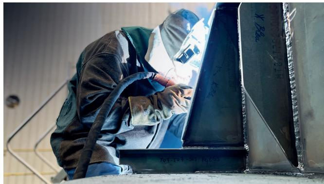
À noter que la conformité des soudures est vérifiée soit par contrôle visuel, par ressage ou tir radiographique afin de s'assurer de la qualité et fiabilité du produit final.
