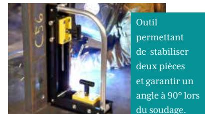
Outil permettant de stabiliser deux pièces et garantir un angle à 90° lors du soudage.
